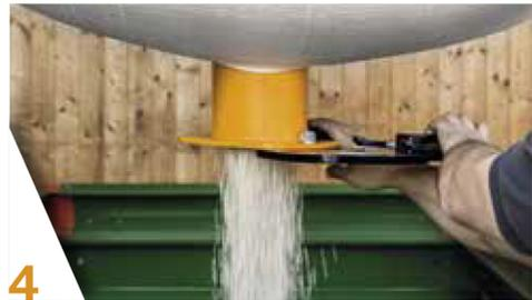
4 Durch einfaches Öffnen und Schließen des FLEDBAG®, lässt sich der Inhalt des Big Bags einfach dosieren.
