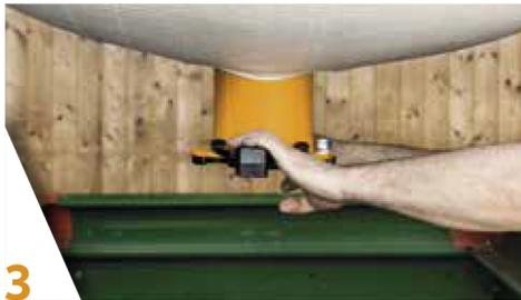
3 Den FLEDBAG® etwas nach unten ziehen, damit das Öffnen und Schließen des Ventils einfach funktioniert.
