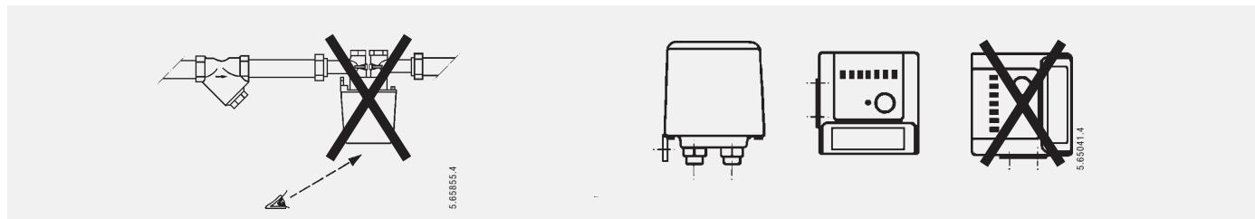
Einbaulage des Zählers (mit oder ohne Impulsgeber): Messgeräte nicht mit dem Ablesekopf nach unten einbauen. Gerade Beruhigungsstrecken sind nicht erforderlich.
