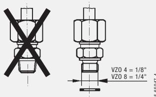
Verschraubungen festziehen. Max. Anzugsdrehmoment 7 Nm.
